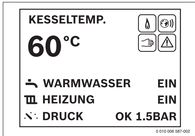
Bild 5 Anzeige des Betriebsdrucks der Heizung in der Standardanzeige
