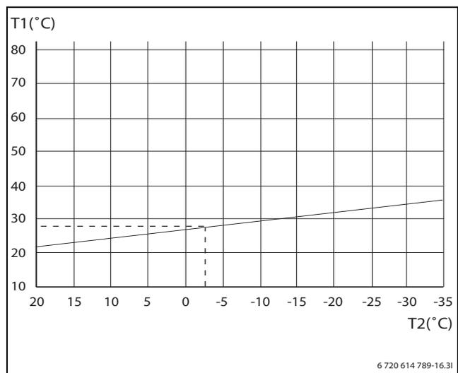
Bild 22 Fußbodenheizung
