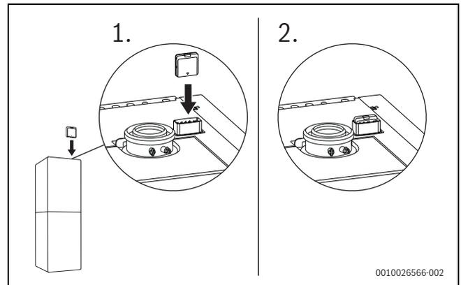
Bild 2 Control Key in den Key-Halter einstecken
